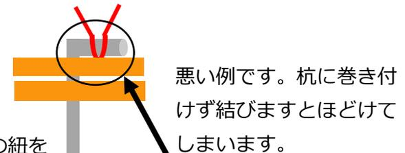
**鉄杭は抜けない、倒れない様グラウンド内にしっかりと固定してください。(ハンマーで固定してください。)**
